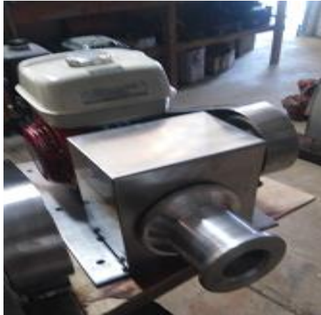
Figura 119. Guinche tipo para levante de línea de cultivo (Fotografía Pedro González).
