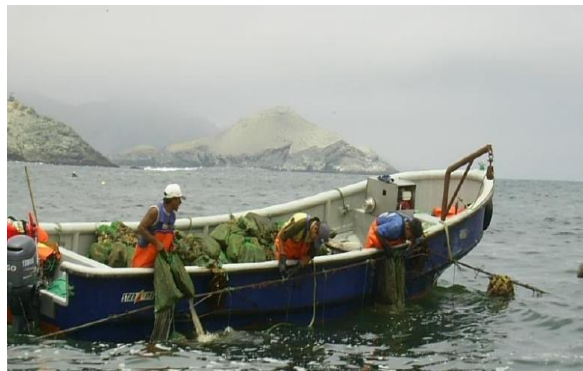
Figura 117. Embarcación fibra de vidrio de 8 metros de eslora, adecuada para el trabajo de cultivo de ostión del norte. Fuente: ( www.gob.pe/fondepes , s.f.).
