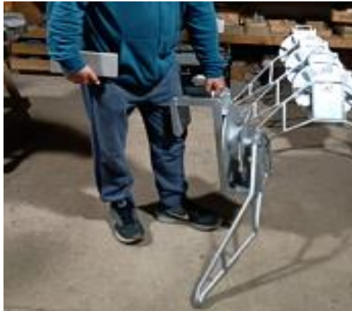
Figura 26. Rolete tipo utilizado para sujetar y recorrer la línea madre al borde de la embarcación. Fuente: (Fotografía Pedro González).
