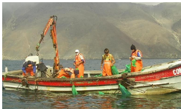
Figura 118. Embarcación de fibra de vidrio de 10,8 metros de eslora, equipada para trabajos en líneas de cultivo de ostión del norte ( www.gob.pe/fondepes , s.f.).
