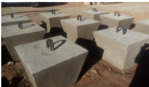
Figura 108. Fondeos de concreto. Fuente: (Fotografía Pedro González).
