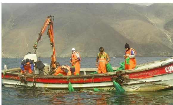
Figura 54. Embarcación de fibra de vidrio de 10,8 metros de eslora, equipada para trabajos en líneas de cultivo de piure ( www.gob.pe/fondepes , s.f.).
