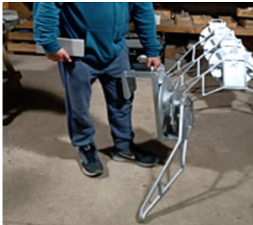
Figura 43. Rolete tipo utilizado para sujetar y recorrer la línea madre al borde de la embarcación. Fuente: (Fotografía Pedro González).
