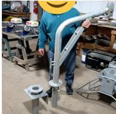
Figura 24. Pescante utilizado para levante de línea madre. Fuente: (Fotografía Pedro González).
