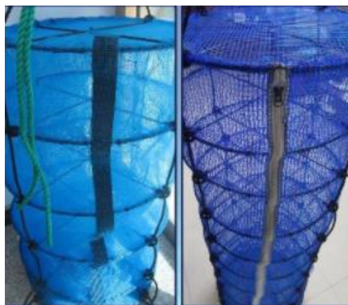
Figura 110. Linternillas para uso de cultivo de semillas de ostión del norte. Fuente: (acuiculturaspya.com, s.f.)
