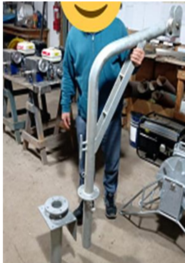
Figura 41. Pescante utilizado para levante de línea madre. Fuente: (Fotografía Pedro González).
