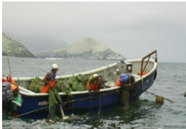
Figura 73. Embarcación fibra de vidrio de 8 metros de eslora adecuada para el trabajo de cultivo de ostión del norte. Fuente: ( www.gob.pe/fondepes , s.f.).
