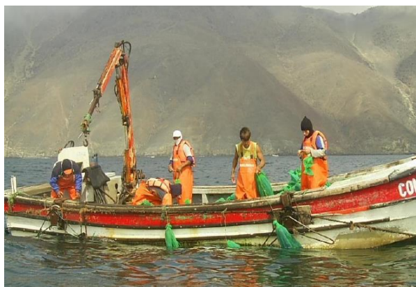
Figura 22. Embarcación de fibra de vidrio de 10,8 metros de eslora equipada para trabajos en líneas de cultivo. Fuente: (www.gob.pe/fondepes, s.f.).
