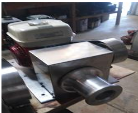
Figura 55. Guinche tipo para levante de línea de cultivo. Fuente: (Fotografía Pedro González).
