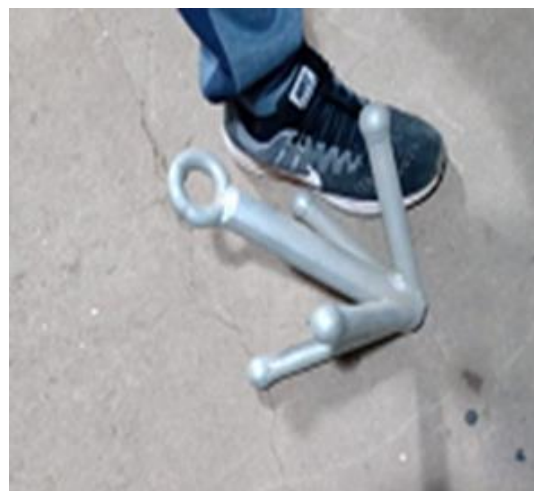
Figura 77. Araña tipo utilizada para atrapar y levantar la línea madre. Fuente: (Fotografía Pedro González).
