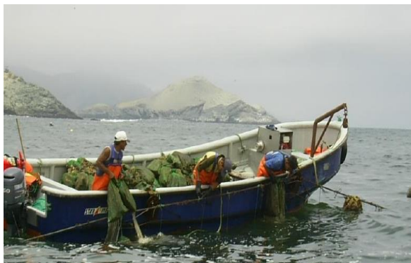
Figura 53. Embarcación fibra de vidrio de 8 metros de eslora, adecuada para el trabajo de cultivo de piure ( www.gob.pe/fondepes , s.f.).
