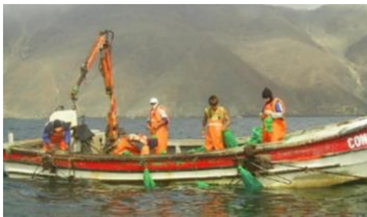
Figura 39. Embarcación de fibra de vidrio de 10,8 metros de eslora equipada para trabajos en líneas de cultivo de ostión del norte. Fuente: (www.gob.pe/fondepes, s.f.).
