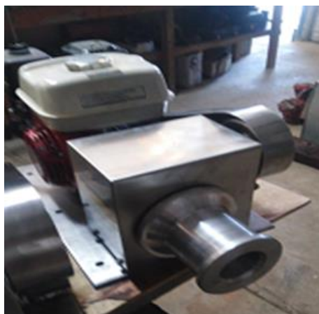
Figura 40. Guinche tipo para levante de línea de cultivo. Fuente: (Fotografía Pedro González).
