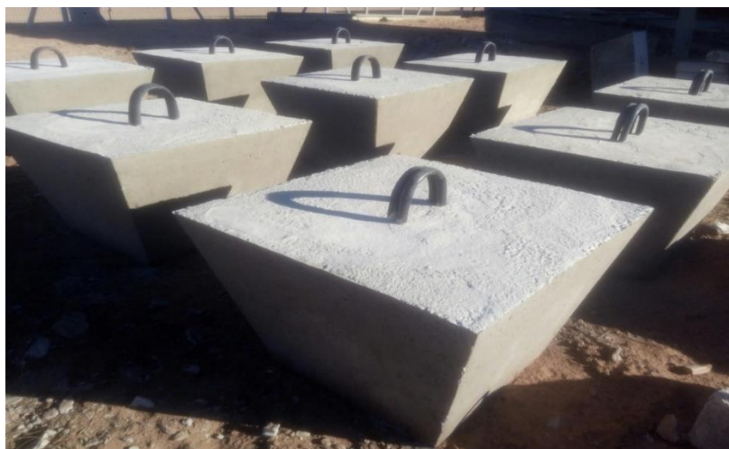
Figura 97. Fondeos de hormigón utilizados en instalación de long line.
