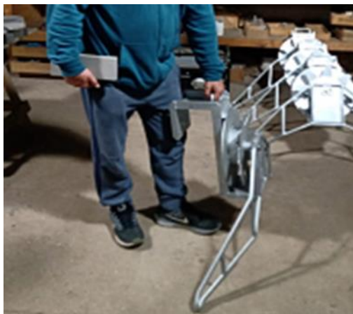
Figura 78. Rolete tipo utilizado para sujetar y recorrer la línea madre al borde de la embarcación. Fuente: (Fotografía Pedro González).
