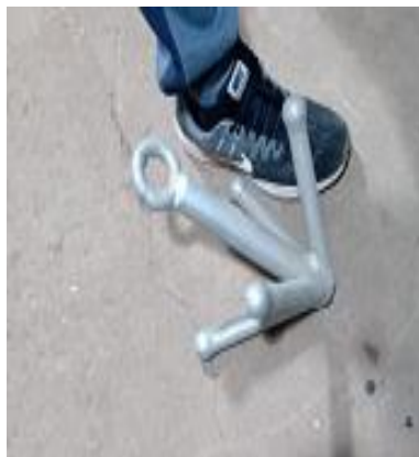
Figura 25. Araña tipo utilizada para atrapar y levantar la línea madre. Fuente: (Fotografía Pedro González).
